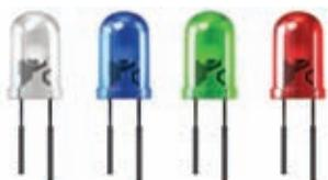
විවිධ හැඩියන් හා විශාලත්වයන් ඇති ආලෝක විමෝශක බියෝඩ වෙළඳපාලේ ඇති අතර වැඩියෙන් ම ප්‍රවලිතව ඇති 5 mm LED එකක, බාහිර පෙනුම සහ අග හඳුනා ගන්නා ආකාරයන්, ආලෝක විමෝශක බියෝඩයක සංකීතයන් 11.18 රුපයේ දැක්වේ. LEDහි දිග අගය ඇනොඩය වේ. එලෙසම LEDහි පාදය අප දෙසට අල්වා බැඳු විට එහි කැපුමට ආසන්න අගුරු කැනෙක්ඩය වේ. රතු, කහ, කොළ සහ නිල් වර්ණ ද පාරුජම්බූල (UV) සහ අධෝරක්ත (IR) කිරණ ද විමෝශනය කළ හැකි LED වෙළඳපාලේ ඇත.
